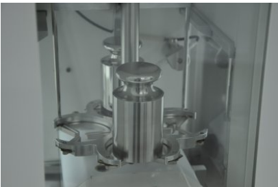
Wzorzec 1 kg i kopia 1 kg w komparatorze stanowiącym stanowisko pomiarowe wzorca państwowego
