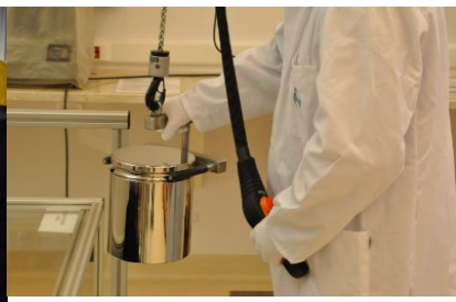
Załadunek wzorca 50 kg do komparatora
