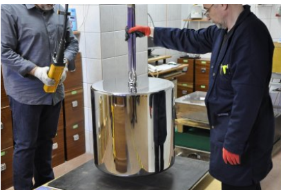
Wzorzec 1000 kg klasy F2 ustawiany na komparatorze
