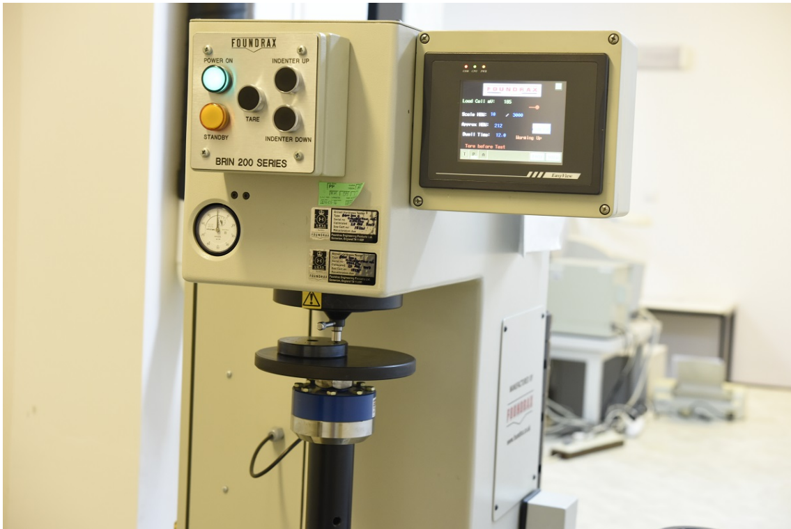
Wzorcowanie wzorca twardości Brinella (skala HBW10/3000) (wykonywanie odcisku Brinella, faza obciążania)
