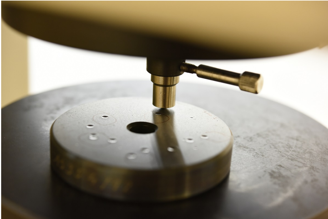
Wzorcowanie wzorca twardości Brinella - faza obciążania
