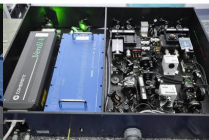
Państwowy wzorzec jednostki długości - syntezer częstotliwości optycznych
