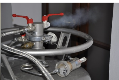
Pomiary w punkcie potrójnym argonu, stanowisko pomiarowe państwowego wzorca jednostki miary temperatury
