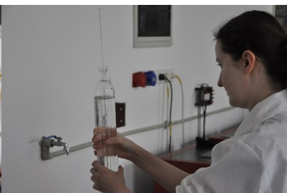
Komórka punktu potrójnego wody, praca przy stanowisku pomiarowym państwowego wzorca jednostki miary temperatury
