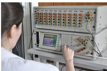
Stanowisko pomiarowe wzorca roboczego w zakresie od -80\text{ }^{\circ}\text{C} do 550\text{ }^{\circ}\text{C}
