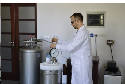
Przygotowania do pomiaru w punkcie potrójnym argonu, stanowisko pomiarowe państwowego wzorca jednostki miary temperatury
