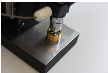
Pomiar głębokości wnęki mikrofonowej przy stanowisku wzorca pierwotnego ciśnienia akustycznego
