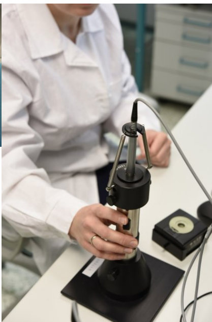
Praca przy stanowisku do wzorcowania mikrofonów pomiarowych i kalibratorów akustycznych
