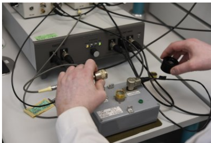
Wzorzec pierwotny ciśnienia akustycznego
