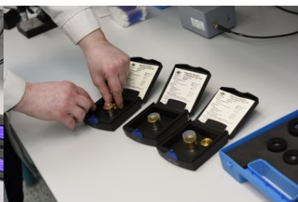
Wzorzec pierwotny ciśnienia akustycznego
