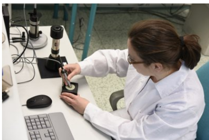
Praca przy stanowisku do wzorcowania mikrofonów pomiarowych i kalibratorów akustycznych
