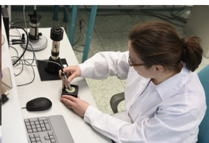
Praca przy stanowisku do wzorcowania mikrofonów pomiarowych i kalibratorów
