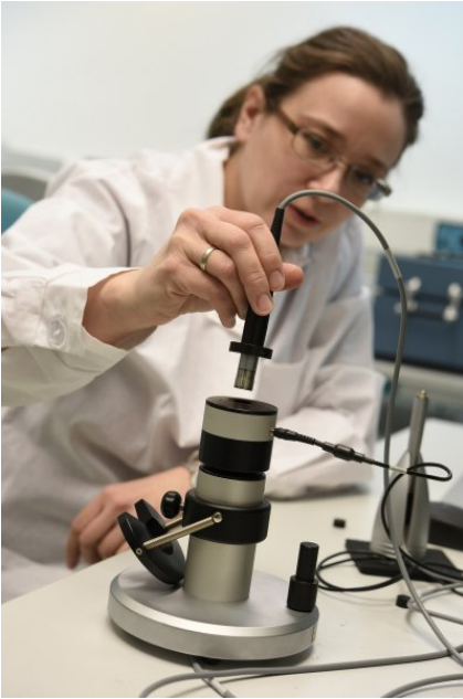
Praca na stanowisku do wzorcowania mikrofonów pomiarowych i kalibratorów akustycznych
