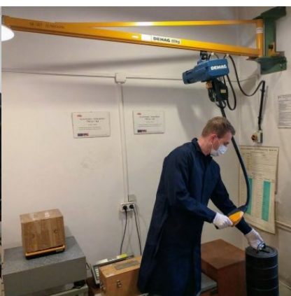
Wzorcowanie wzorca masy o nominalnie 25 kg
