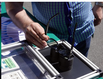
Pomiar skuteczności ograniczania promieniowania UV przez okulary przeciwsłoneczne
