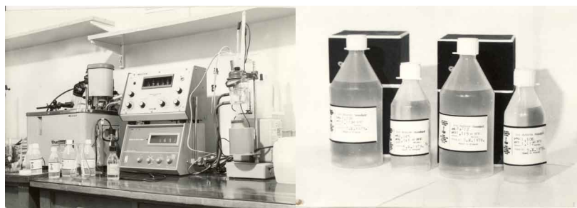
Stanoisko do pomiarów aktywności jonów oraz wzorce aktywności jonów (lata 70 XX w.)
