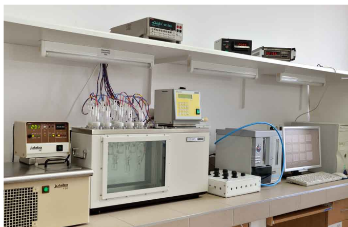
Stanowisko państwowego wzorca jednostki miary pH odtwarzającego wartość pH metodą podstawową oraz decyzja Prezesa GUM o jego uznaniu z 2003 r.
