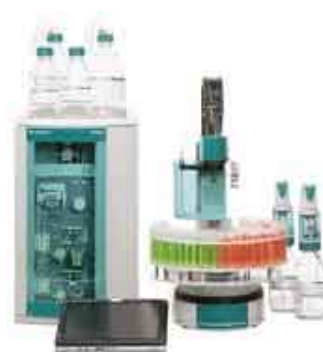
Stanowisko państwowego wzorca jednostki miary liczności materii – mola, wyposażone w urządzenie do precyzyjnego miareczkowania kulometrycznego oraz w chromatograf jonowy (planowane do zakupu)
