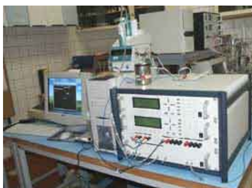
Stanowisko państwowego wzorca jednostki miary liczności materii – mola, wyposażone w urządzenie do precyzyjnego miareczkowania kulometrycznego oraz w chromatograf jonowy (planowane do zakupu)
