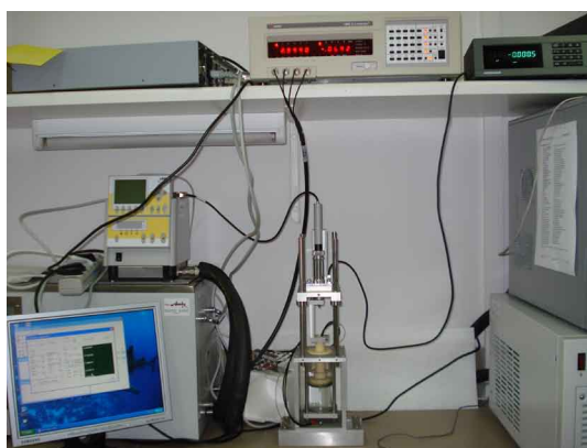
Stanowisko państwowego wzorca jednostki miary przewodności elektrycznej właściwej – S/m, wykorzystujące „tłokowe” naczynie konduktometryczne (w trakcie budowy)
