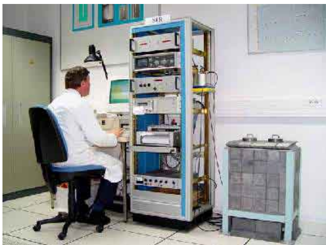
Rys. 7. Nowe laboratorium SIR w BIPM. Z prawej strony znajdują się 2 komory jonizacyjne wewnątrz osłony z bloków ołowiu Źródło: BIPM
