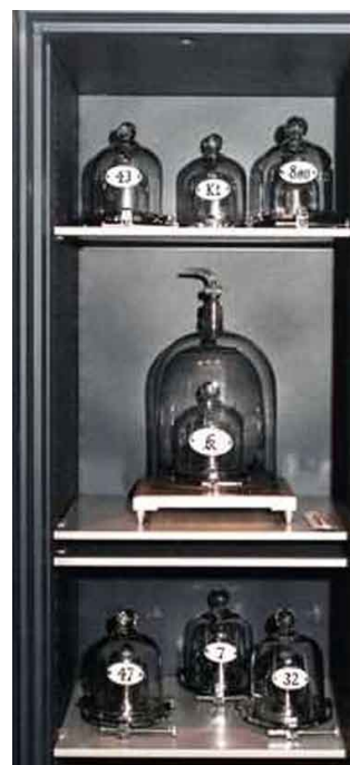
Rys. 3. Międzynarodowy prototyp kilograma wraz z sześcioma „kopiami oficjalnymi” przechowywany jest w sejfie BIPM do dziś, w warunkach określonych w 1889 r. przez 1 CGPM
