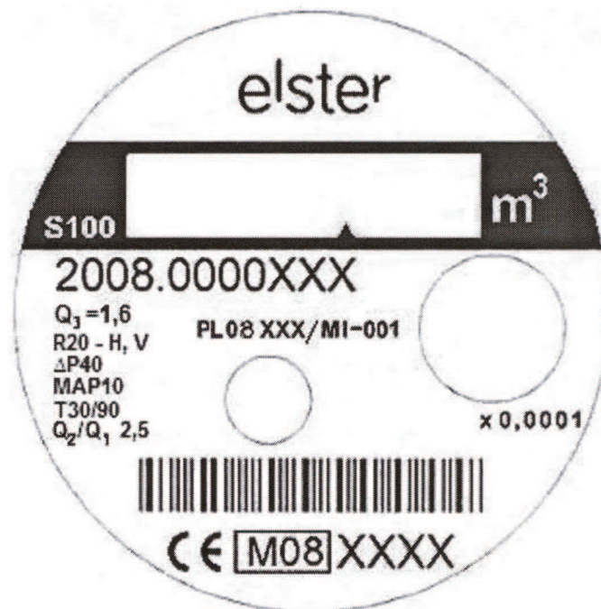
Rys. 3. Wzór podzielnicy wersji podstawowej wodomierza S100 do wody ciepłej (przykład).
